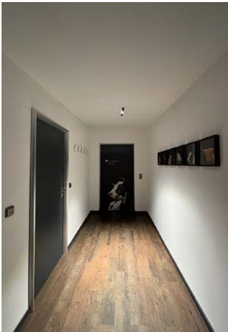
Konzentriertes Licht am Boden, Wände wenig ausgeleuchtet
